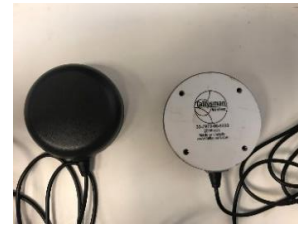
Fig. 6. Tallysman TW7872 antennas.
