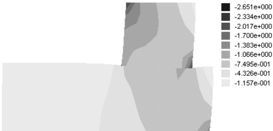
**Figure 6.** *Isovaleurs de déformations de compression  $E_{yy}$*
