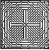
Figure 7. Pire solution pour la plaque encastrée en flexion
