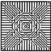
Figure 5. Orientation optimale des fibres dans la plaque encadrée
