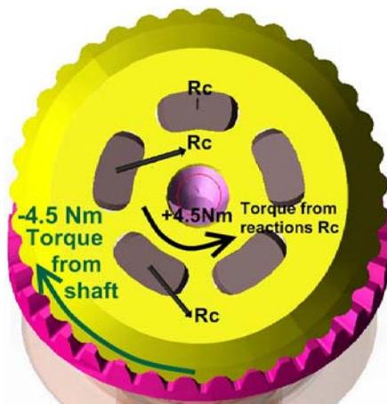
Fig. 33: Reactions  $R_c$ ,  $\vartheta = 38$
